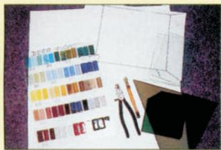
**1** Možnosti uplatnění odvizi od nabídky barevného skla speciálně pro fusing. TGK nabízí možnost vybrat si z praktického vzorníku (sklo před a po speciální). Dále budeme potřebovat rezák a rozlamovací kleště.
