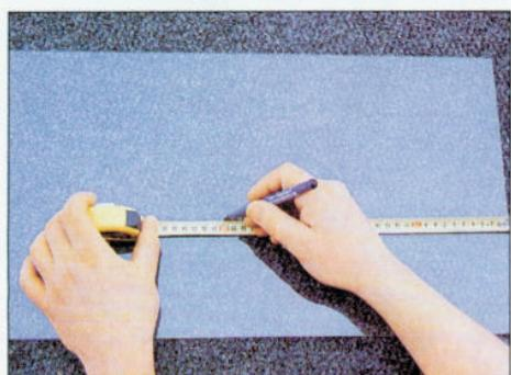
**1** K odměření požadovaného rozměru je zapotřebí svinovací metr a lihový (nemazavý) fix. Linii řezu si pak můžete fixem na tabulce skla vyznačit.
