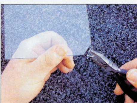
**6** K odlamování malých kousků se používají vylamovací kleště. Potřebujete hlavně u malých výrezů nepravidelného tvaru (tiffany technika).
