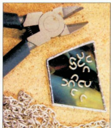
**5** Spojovací očka snadno stočíte ze silnějšího měděného drátka. Lze však použít i řetízek, který pomocí štipáček rozeberete a připravíte si z jeho jednotlivých částí očka ve tvaru písmene U. Před pájením nezapomeňte každé odmastit a potřít letovací vodou
