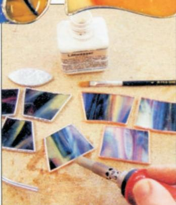
**3** Po zabroušení sklíčka otřete vodou s přídavkem jaru, osušte je a jejich hrany olepte samolepicí měděnou páskou. Olepené hrany potáhněte vrstvou cínu z hrotu rozzhavené pásky. Před pájením nezapomeňte potřít všechny mědi olepené linie letovací vodou
