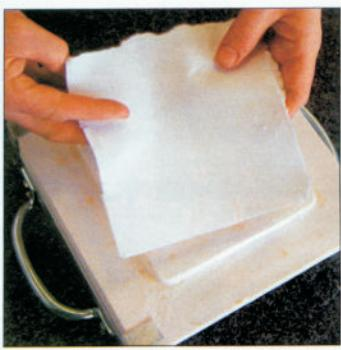
**1** Pec se skládá ze tří částí. Dno, na které je zapotřebí položit vrstvu tzv. fázového papíru, je zaměnitelné s víkem
