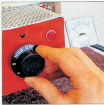
**4** O průběh teplotní křivky v peci se stará termostat. Stačí nastavit vhodný typ křivky podle velikosti spékaného skla
