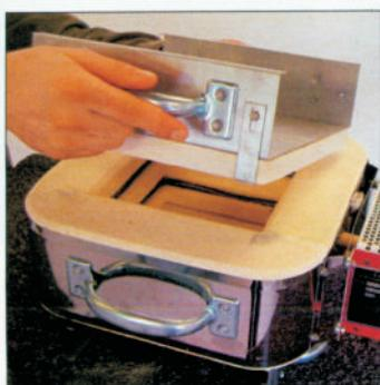
**3** Po naplnění pícku přiklop-te víkem a zapojte do sítě. O další se již postará přesně nastavená automatika
