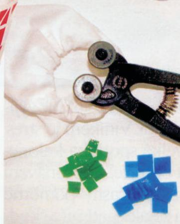
**S těmito kleštěmi s plátěným váčkem (slouží k zachycování úlomků) si přípravu velkého počtu střípek stejného tvaru usnadníte. K dostání jsou za 650 Kč**
