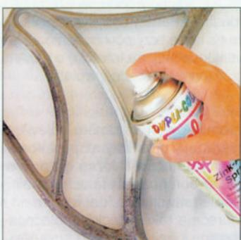
**3** Na očistěný povrch můžete nanést reaktivní aluminium-zinkovou barvu ve spreji. Nezapomeňte díly podložit papírem. Na slunci se barva rychle vytvrdí
