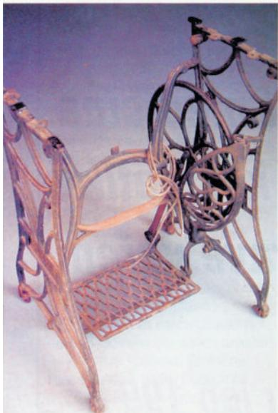
Ani v případě, že zavíte starý stroj desky a nečistot, nebude jeho vzhled příliš vábný. Tady pomůže celková rekonstrukce. Pokuste se ale zavit litinovou podstavu i zbytečné pohonné „jednotky“
